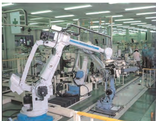
産業用ロボットの製造プロセス（㈱安川電機提供）
